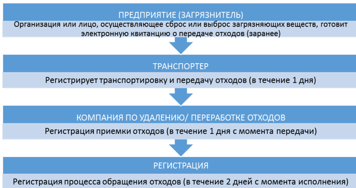
Рис. 3. Схема работы системы «All Baro»
