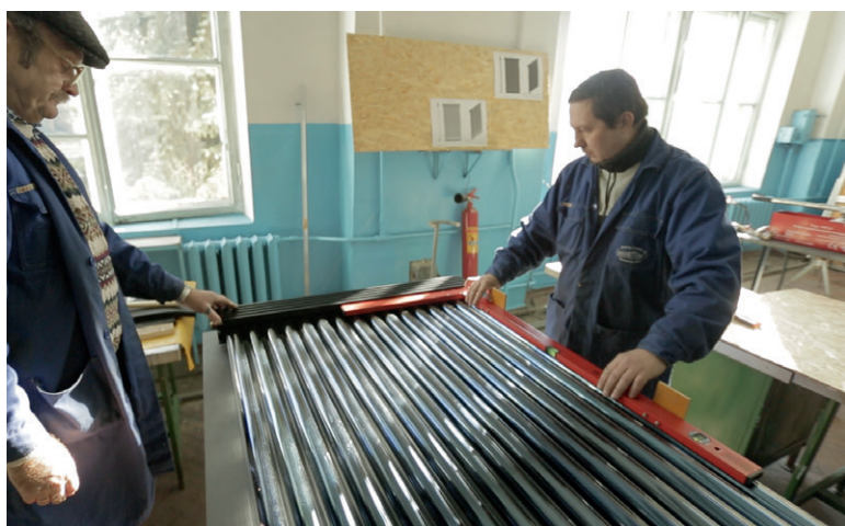
Производство солнечных тепловых коллекторов на местном предприятии в Молдове.
