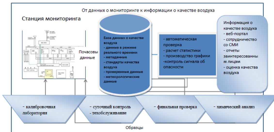
Рис. 32 Основные потоки данных и процессы, связанные с эксплуатационным мониторингом качества воздуха
