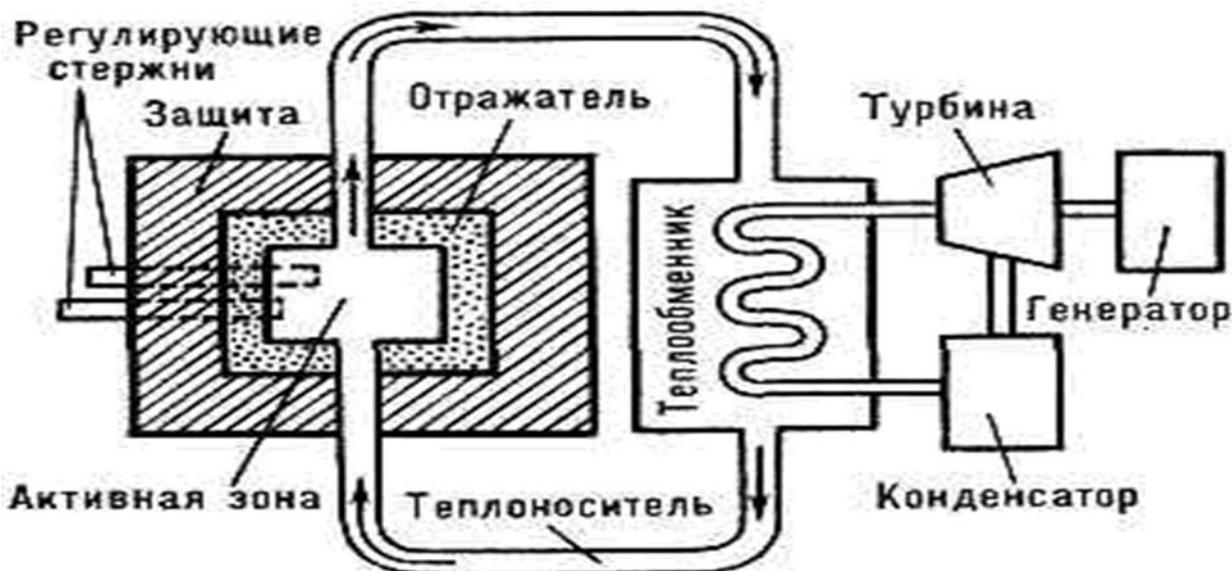
Рисунок 2 – Структура ядерного реактора<sup>5</sup>
